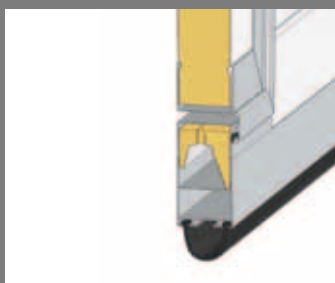
Nízký práh výška prahu 90+20 mm
