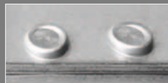
Tox moderní způsob spojování
