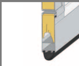
Standardní práh výška prahu 140+20 mm
